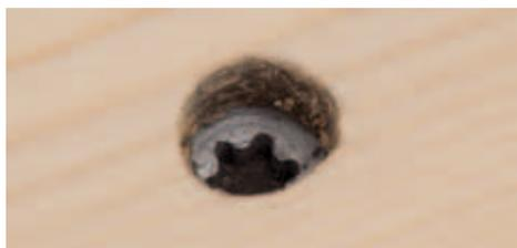
Il n'est pas difficile de poser correctement la vis MMS-TC avec la bonne profondeur de vissage en utilisant l'embout de vissage approprié (voir tableau de la gamme de produits). La surface de l'embout est pourvue d'une graduation pour la profondeur de vissage. Il est possible de régler l'épaisseur de la pièce à fixer sur l'outil à l'aide d'une bague en caoutchouc. La vis présente ainsi la profondeur de vissage optimum.
