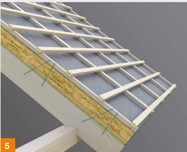
Ohne Schubholz, 90° - 60° Verschraubung mit druckweichem Dämmstoff
