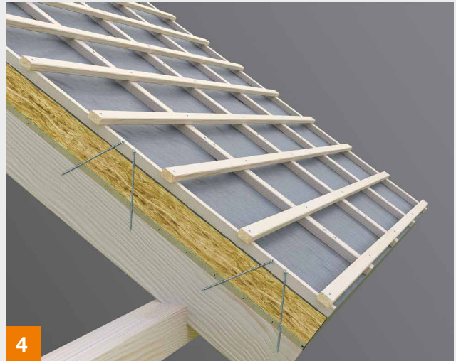
Ohne Schubholz, V-Verschraubung mit druckweichem Dämmstoff
